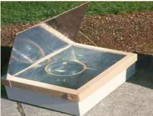
ابتكر سلاح الصيانة الملكي بالأردن موقداً يعمل بالطاقة الشمسية دون الحاجة إلى وقود ويتمتع بكفاءة حرارية هائلة. ويمكن الموقد المبتكر استخدامه من طهي أي نوع من الطعام باستخدام الطاقة الشمسية دون الحاجة إلى وقود إذ تصل درجة الحرارة المستمدة من الشمس 210 درجات مئوية داخله، كما أنه معزول عزلاً تاماً، ما يحسن من كفاءته الحرارية. ومن مميزات الجهاز الذي أصبح يستخدم في القوات المسلحة الأردنية، ما يتمتع به من درجة أمان كبيرة جداً، عدم تسببه بأي أخطار، كما يعتبر صديقاً للبيئة.
